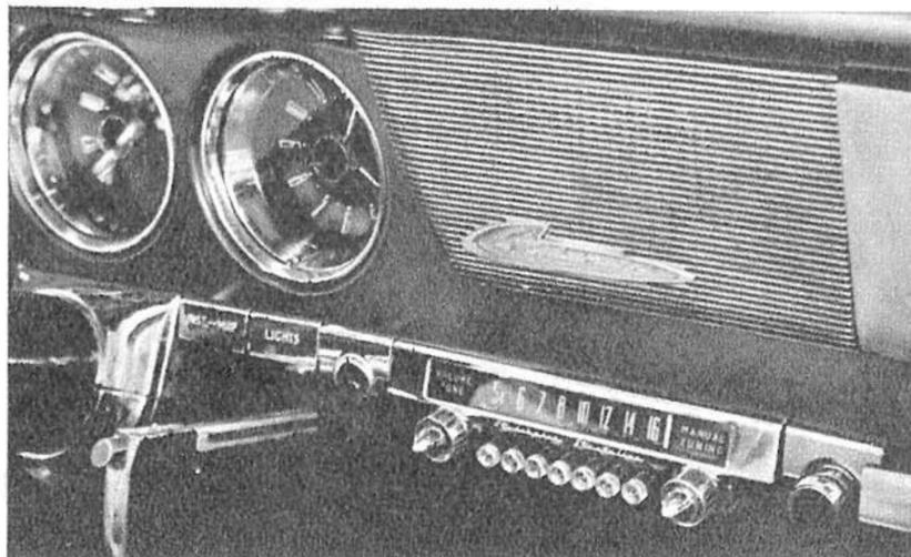
Links: Autoempfänger im amerikanischen Studebaker. Die große Skala (kHz) sowie Druckknopfwähler unterscheiden dieses Gerät von den üblichen deutschen Autosupern. In der Mitte des Armaturenbrettes die besonders verkleidete sehr große Lautsprecheröffnung
