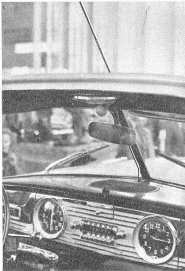
Beim amerikanischen Hudson ist der Autosuper in seinem Äußeren sorgfältig dem Stil des Armaturenbrettes angepaßt. Die Antenne wird auf dem kürzesten Wege hinter dem Mittelpfosten der Windschutzscheibe in den Empfänger eingeführt. Der Lautsprecher im pulmartigen Armaturenbrett (Mitte des Bildes) strahlt nach oben
