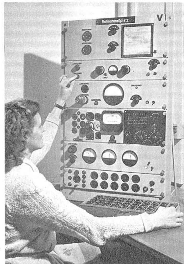
Links: Der vorbildliche Röhrenmeßplatz erlaubt die gleichmäßig einwandfreie Bestückung aller an die Sender weiterzuleitenden Geräte. Mit dem Meßplatz kann eine schnelle und genaue Auswahl von Gegentaktrohren oder die Beurteilung der Klangfestigkeit von Röhren durch ihre Untersuchung in motorisch bewegten Rüttelfassungen durchgeführt werden
